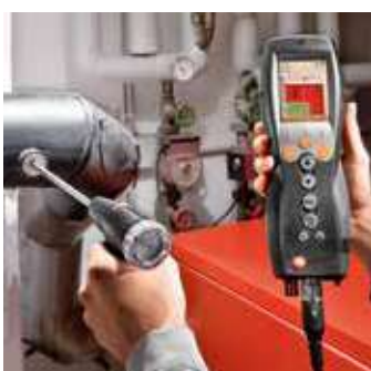
testo 330の1台で、効率よく燃焼管理
