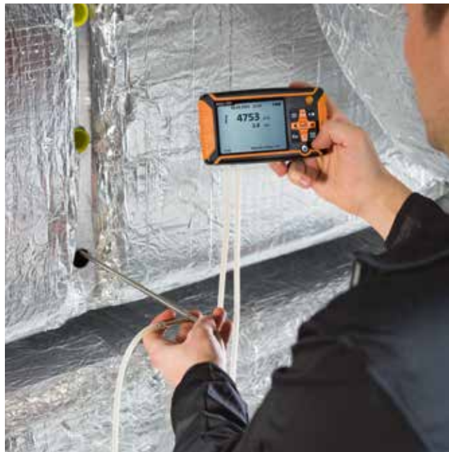
差圧計としてダクト内のピトー管測定 (ピトー管は別途ご注文ください)
