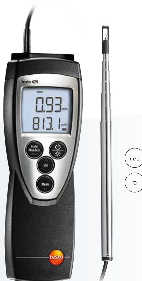
testo 425 は、すべてのレンジで 0.01 m/s の分解能で測定可能な熱線式風速計のスタンダードモデルです。プローブ先端は直径7.5 mmで、最長820mmまでの伸縮可能なロッドが付いており、エアコンなどの吹き出し口や換気ダクト内に挿入して風速を測定することができます。
