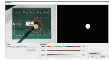
画像認識イメージ (プローブ先端の黄色を認識)
